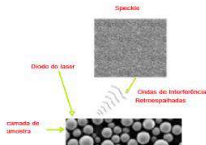
FIGURA 9 PRINCÍPIO DE FUNCIONAMENTO DA TÉCNICA DE DWS.
