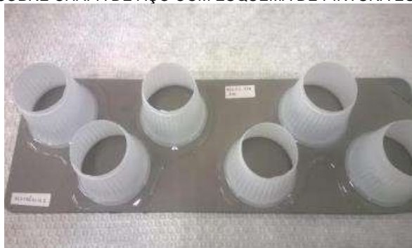
FIGURA 15 REGISTRO FOTOGRÁFICO DO SISTEMA DE DISPOSIÇÃO DOS CORPOS DE PROVA SOBRE CHAPA DE AÇO COM ESQUEMA DE PINTURA ESTUDADO.
