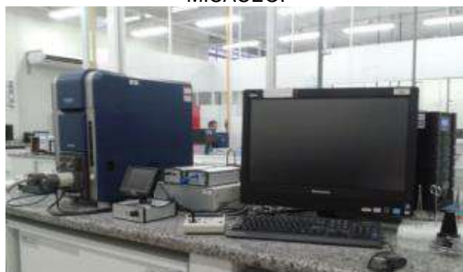
FIGURA 12 MICROSCOPIO ELETRÔNICO DE VARREDURA, UTILIZADO NAS ANÁLISES DA GEOMETRIA DAS PARTÍCULAS DOS PIGMENTOS DE ÓXIDO DE FERRO E ÓXIDO DE FERRO MICÁCEO.
