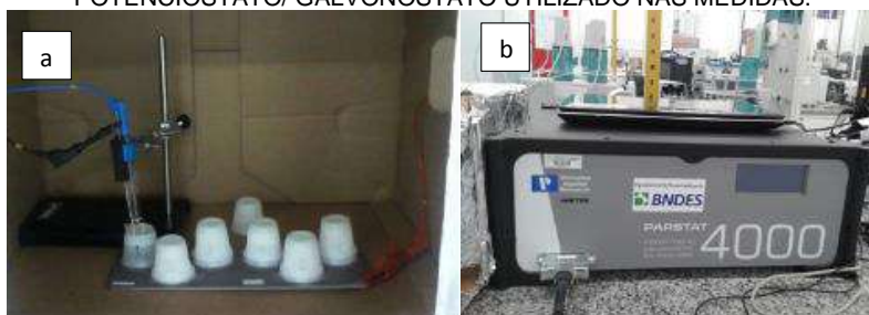
FIGURA 16 (a)REGISTRO FOTOGRÁFICO DA PARTE EXPERIMENTAL (AMOSTRA MAIS ELETRODOS DE TRABALHO, CONTATO E REFERÊNCIA – CÉLULA ELETROQUÍMICA) E (b) O POTENCIOSTATO/ GALVONOSTATO UTILIZADO NAS MEDIDAS.
