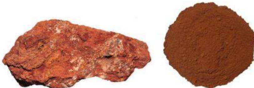
FIGURA 7 FOTO DA ROCHA DE ÓXIDO DE FERRO AMORFO E DO PIGMENTO DE ÓXIDO DE FERRO AMORFO PRONTO PARA USO.
