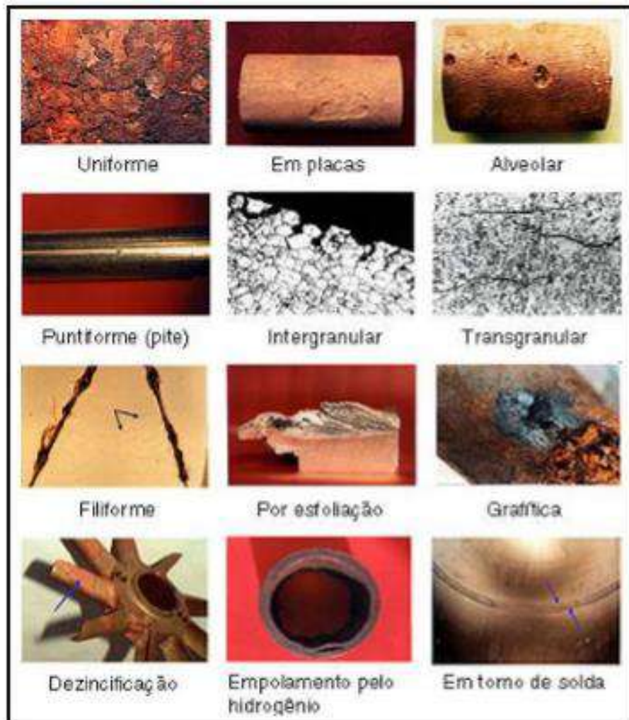
FIGURA 1 TIPOS DE CORROSÃO
