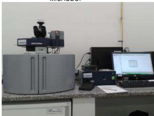
FIGURA 13 ESPECTROFOTÔMETRO RAMAN, UTILIZADO PARA CONFIRMAÇÃO DA COMPOSIÇÃO QUÍMICA DOS PIGMENTOS DE ÓXIDO DE FERRO E ÓXIDO DE FERRO MICÁCEO.
