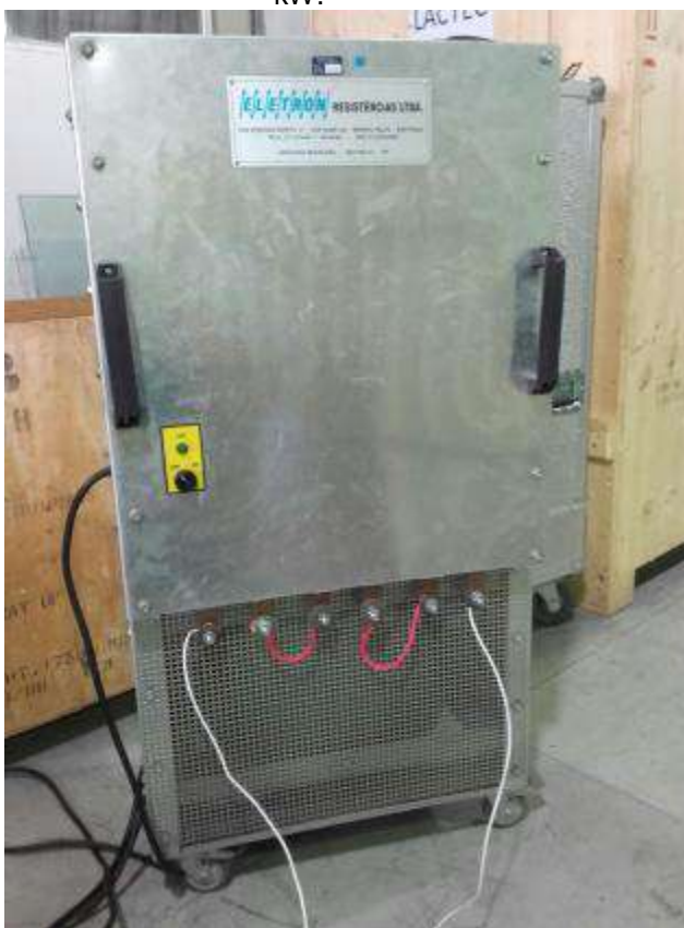
FIGURA 19 – ESQUEMA DE LIGAÇÃO EM SÉRIE DO BANCO DE RESISTÊNCIAS DE 3x10 kW.
